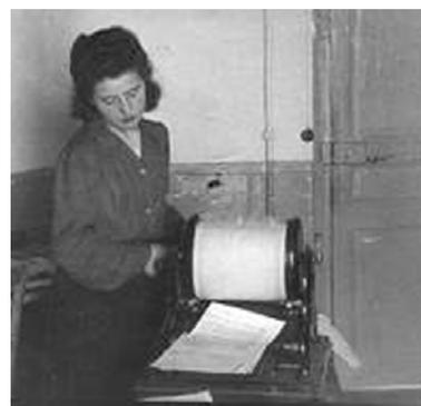
Le stencil a été placé sur un rouleau que l'on fait tourner manuellement. Les feuilles sont alors imprimées une à une, jusqu'au moment où le stencil devient inutilisable.
